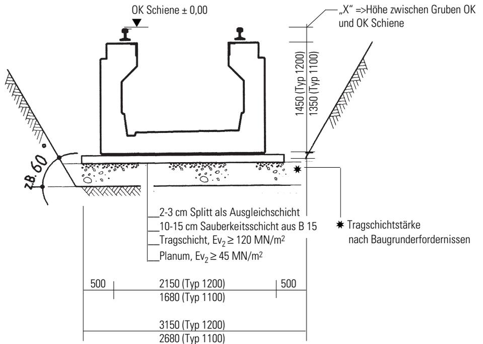
Die Böschungsneigung ist unabhängig vom vorgefundenen Baugrund.
